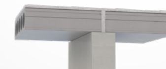
Železobetónová prievlaková konštrukcia
